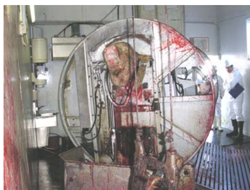
Figur 9. Rotationsboxen tas tillbaka till startläget, och fixeringen om djurets kropp lossas.
