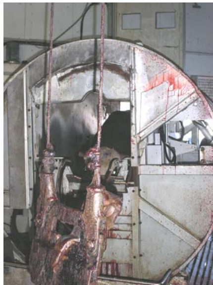
Figur 3. Djuret går in i rotationsboxen. (I förgrunden ses en del av utrustningen för länkning av slaktkroppen.)
